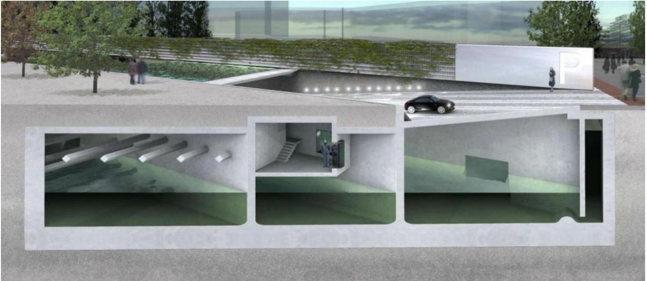
(Fig. 2) La sezione mostra il riempimento dei serbatoi posti sotto il parcheggio del Museumparkgarage nel caso di pioggia abbondante. Come si evince, il riempimento dei vani sottostanti non inficia la funzionalità del servizio di rimessaggio delle auto (Comune di Rotterdam).
